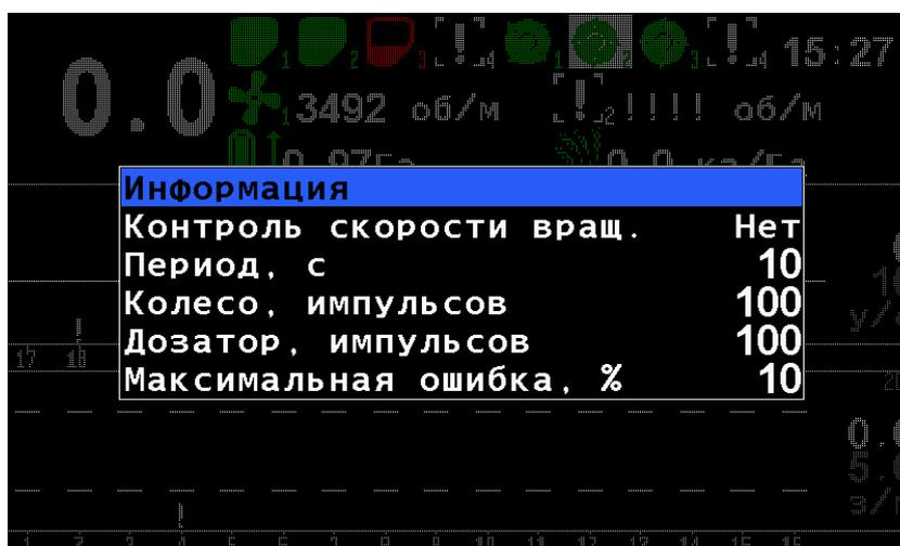
РИСУНОК 20 ПАРАМЕТРЫ ДОЗАТОРА
