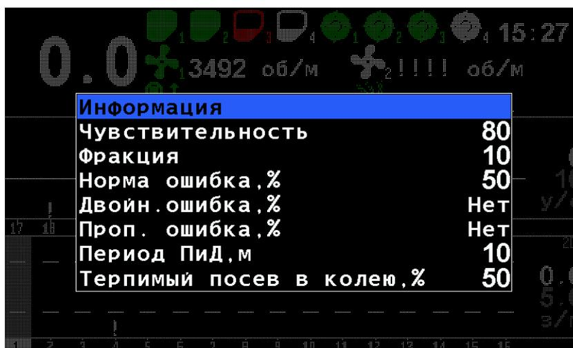
РИСУНОК 23 ПАРАМЕТРЫ ДАТЧИКА ВЫСЕВА
