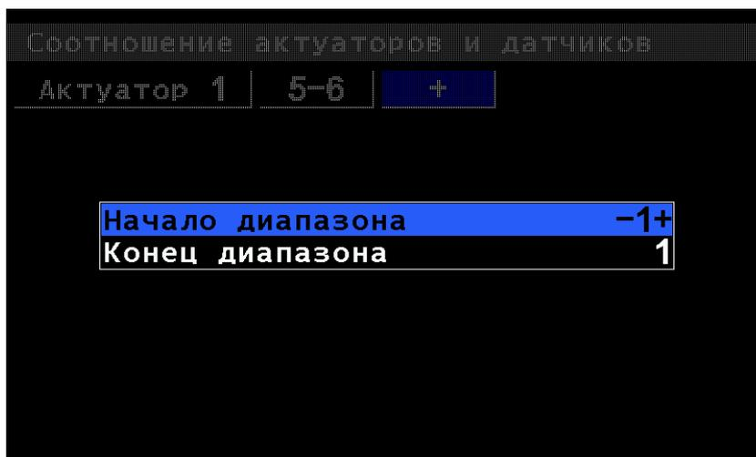
*Рисунок 43 Меню добавления нового диапазона номеров датчиков высева*
