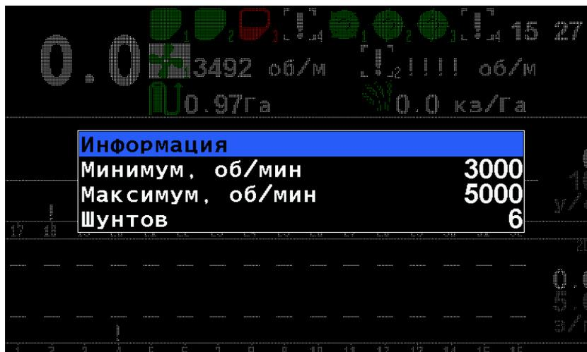
РИСУНОК 21 ПАРАМЕТРЫ ВЕНТИЛЯТОРА
