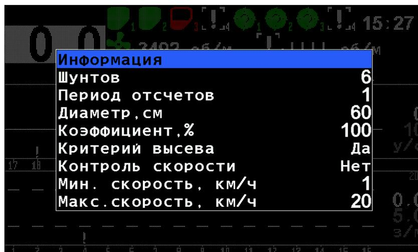
*РИСУНОК 22 ПАРАМЕТРЫ ДАТЧИКА СКОРОСТИ*
