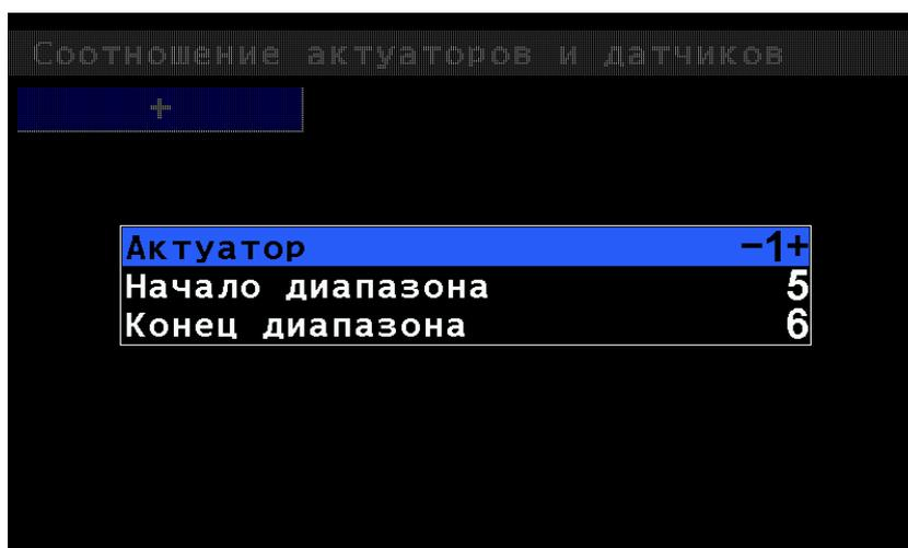
*Рисунок 42 МЕНЮ ДОБАВЛЕНИЯ СООТВЕТСТВИЯ ДАТЧИКОВ ВЫСЕВА АКТУАТОРУ*
