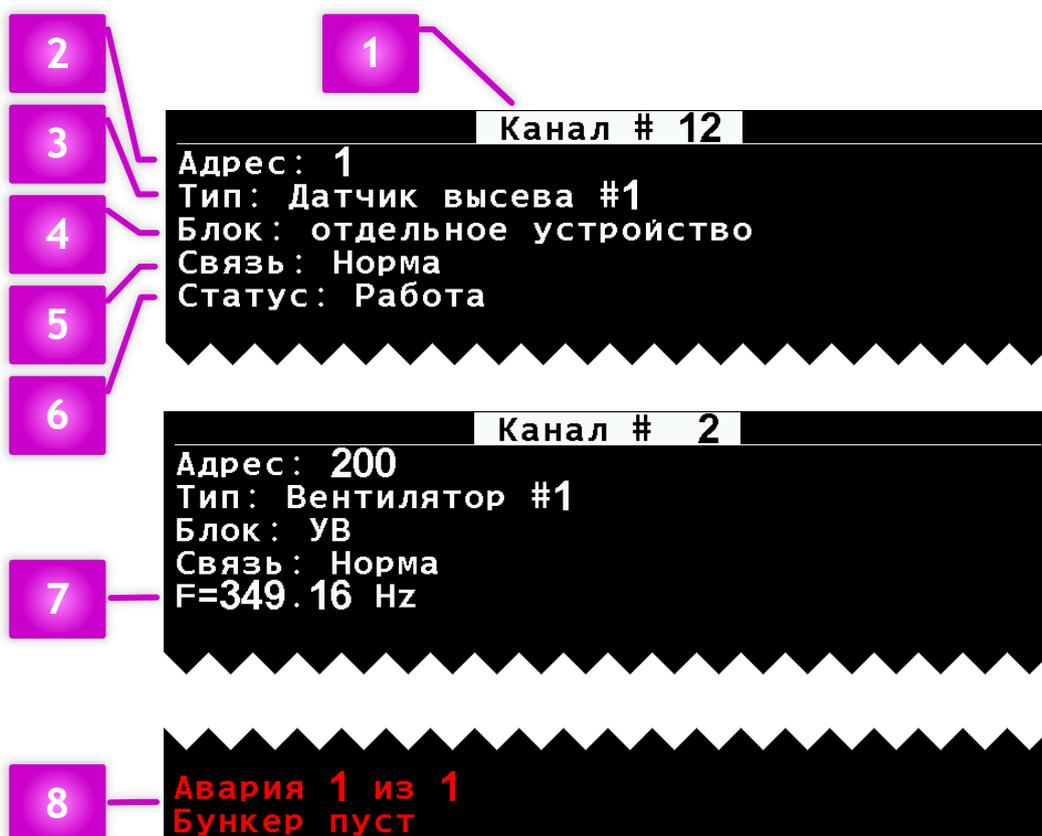
*РИСУНОК 18 ЭКРАН "ПРОСМОТР СОСТОЯНИЯ"*
